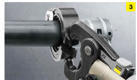
Der Verbinder wird mit einer Viega Pressmaschine sekundenschnell verpresst und kraftschlüssig mit dem Rohr verbunden.
