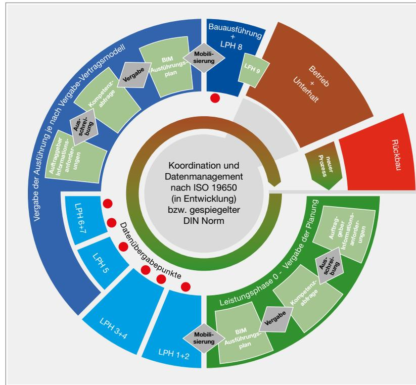
Abb. 6: BIM-Referenzprozess (Quelle: Stufenplan Digitales Planen und Bauen)
