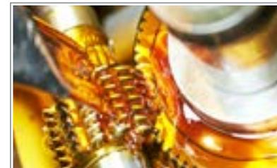
Abb. 89: Anwendung eines Kühlschmierstoffs
