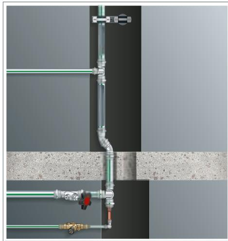
Abb. 19: Inliner-Zirkulationssystem in Edelstahlrohr
