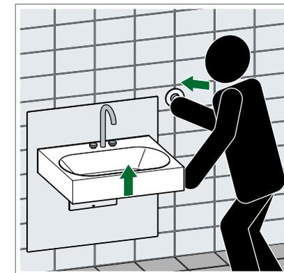
Abb. 16: Waschtisch anheben durch Federkraft
