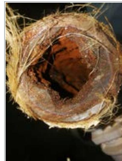
Abb. 8: Verzinktes Stahlrohr mit deutlich sichtbarer Korrosion
