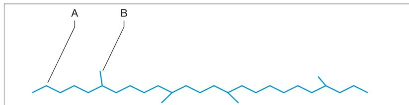
Abb. 4: Schematische Darstellung von FKM
