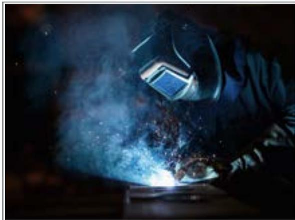
Abb. 61: Schutzgasschweißen
