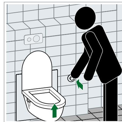
Abb. 22: WC anheben durch Federkraft – ein Elektroanschluss wird nicht benötigt.
