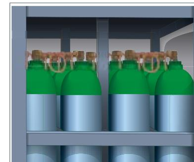
Abb. 73: gesicherte Flüssiggasflaschen
