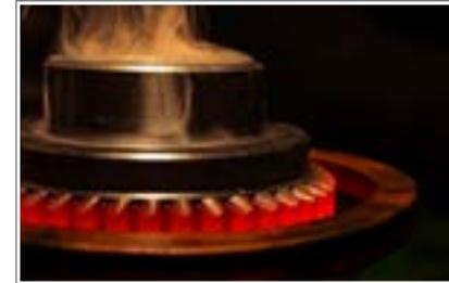
Abb. 62: Schutzgasofen zur Härtung von Zahnrädern
