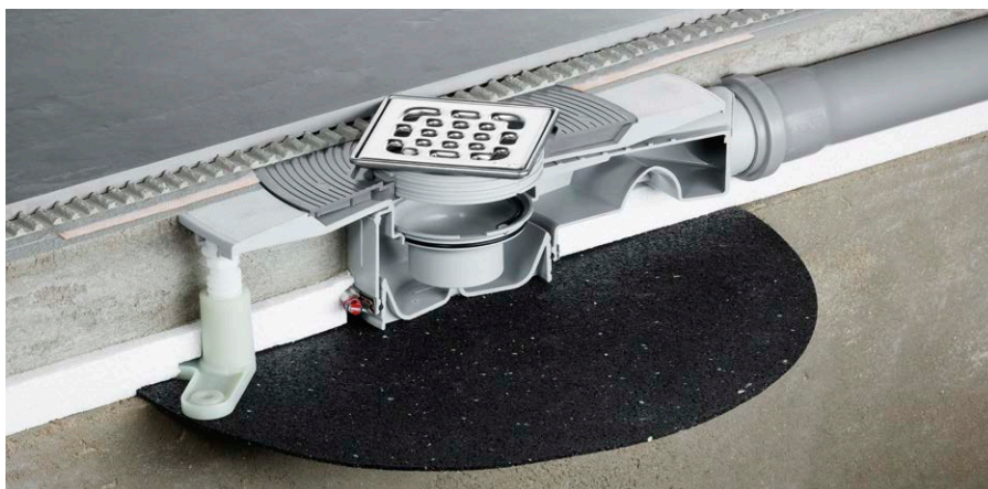
Advantix Top-Ablauf rücksaugssicher durch Sperrwasserbarriere mit mittlerer Durchlauföffnung und seitlichen Stautaschen.
