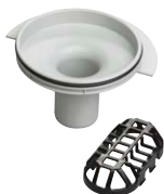
senkrechtes Modell, ohne Geruchverschluss, mit Siebeinsatz, Ablaufleistung Anstauhöhe 10 mm 1,2 l/s, Ablaufleistung Anstauhöhe 20 mm 1,2 l/s Modell 4982.83
