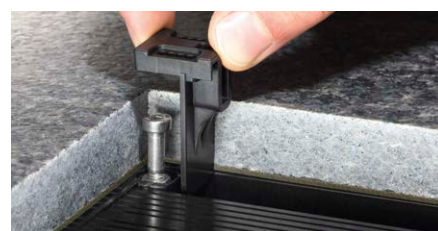
Mit dem zusätzlich erhältlichen Natursteinset kann der Rost auf eine Fliesenstärke von max. 33 mm angepasst werden (Fliese + Kleber).
