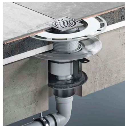
Brandschutzablauf R 120 , senkrechte Ablaufinstallation für flache Aufbauhöhen und den Einsatz in der Verbundabdichtung.
