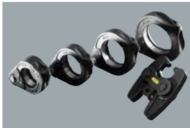
Abb. 9 – 11 Pressringe und Gelenkzugbacke
