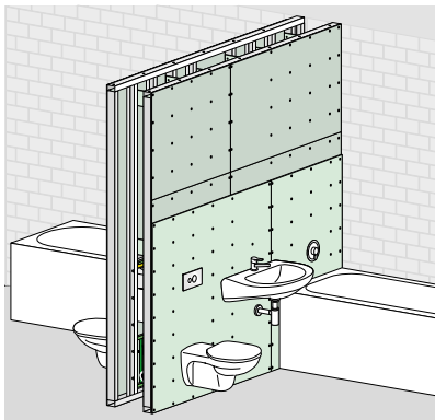
Abb. 154: Viega Eco Plus leichte Trennwand mit Beplankung
