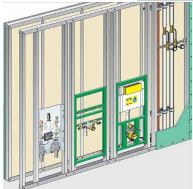
Abb. 148 Spülstation im konventionellen Trockenbau
