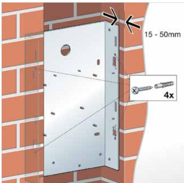
Abb. 151 Spülstation – Unterputz-Installation
