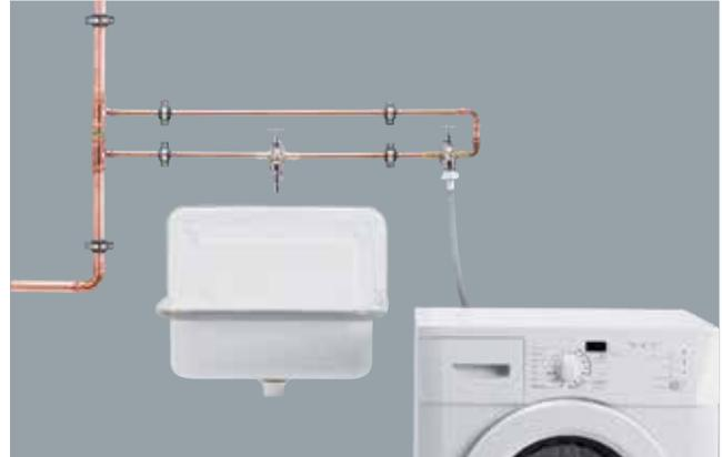
Abb. 72 Zwei Entnahmestellen – Installationsbeispiel
