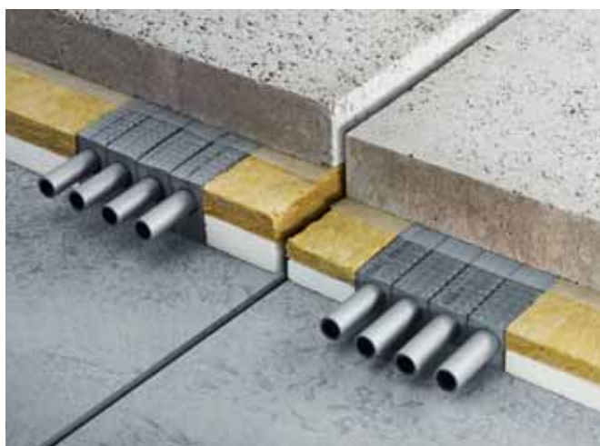
Für die Dämmung von Heizungsrohren im Fußbodenaufbau gegen Erdreich oder unbeheizte Räume nach EnEV, Anlage 5, Tabelle 1, Zeile 7 steht die 100%ige Dämmung zur Verfügung. Für verminderte Anforderungen zur Dämmung gegen beheizte Räume unterschiedlicher Nutzer eignet sich die 9-mm-Exzentroflex-Dämmung.
